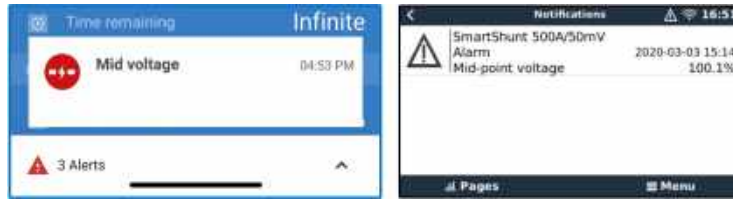
Links: alarm weergegeven in de VictronConnect-app. Rechts: alarm weergegeven op een GX-apparaat.
